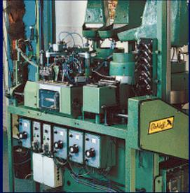
Depuis 1988, le "Grünes Monster" assemble des chaînes adaptées à tous types de situations, pour pignons à 8, 9 vitesses et bien sûr moyeux **SPEEDHUB 500/14**. Leur coriacité aide à oublier les tracasseries de la boue, du sable et des manques de soin ... Néanmoins, et jusqu'en 2011, le monstre va prendre un peu de repos réparateur pour un nouveau projet: une chaîne spéciale single-speed pour moyeux à vitesses encore plus résistante!
