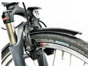
Überragend: Magura HS22-Felgenbremsen mit roten Belägen!
