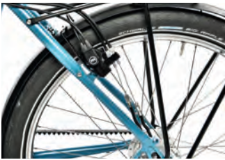
Die Züge für die interne Schaltansteuerung der Rohloff.
