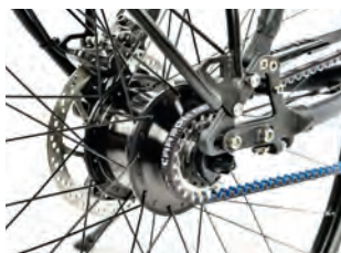
Rohloff und Riementrieb: wartungsarm im Einklang.
