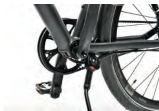
Öffnung am Unterrohr, Exzenter-Tretlager und Mittelständer.
