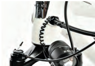
Ungewöhnliche Optik des Kabeleinlasses am Steuerrohr.
