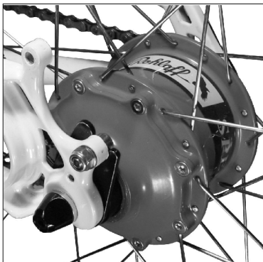
Rohloff SPEEDHUB 500/14 CC OEM2 montiert mit Stützschaube an IS 2000 Bremsaufnahme
