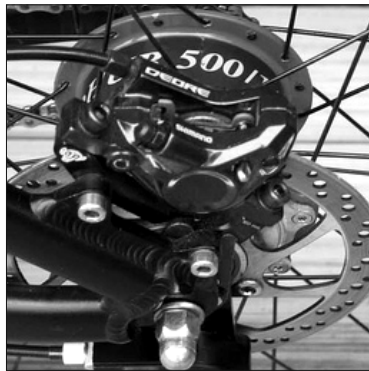
Rohloff SPEEDHUB 500/14 TS DB OEM2 montiert mit Rohloff MONKEY BONE (IS-PM Adapter) und PM Scheibenbremse
