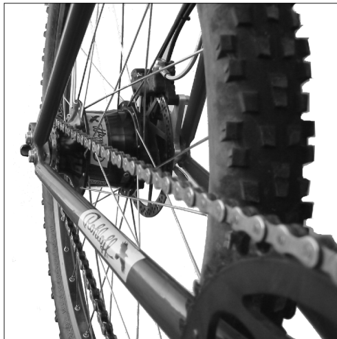
Rohloff SPEEDHUB 500/14 CC DB OEM montiert in Rahmen mit verschiebbaren Rohloff OEM Ausfallenden
