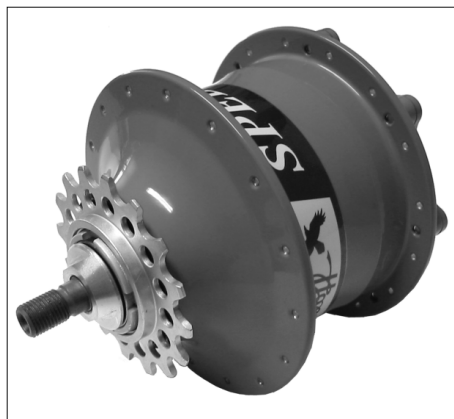
Rohloff SPEEDHUB 500/14 TS (Schraubachse)
