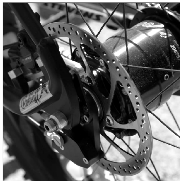
Rohloff SPEEDHUB 500/14 XXL A12 DB OEM2 montiert mit Rohloff FAT BONE und Scheibenbremse
