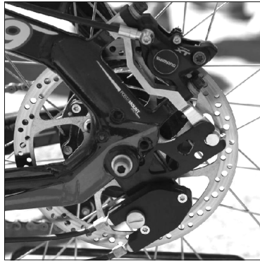
Rohloff SPEEDHUB 500/14 A12 DB PM montiert mit Rohloff PM BONE (PM-PM Adapter) und PM Scheibenbremse
