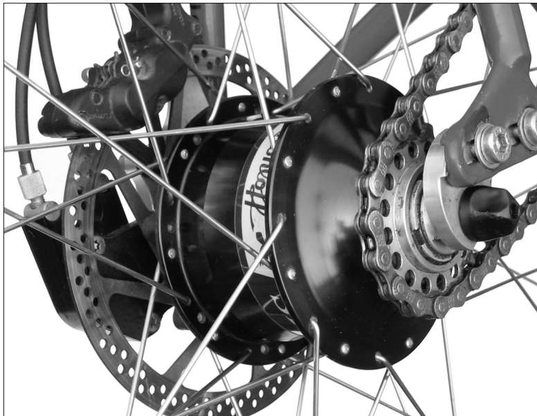
Rohloff SPEEDHUB 500/14 CC DB OEM montiert in Rahmen mit verschiebbaren Rohloff OEM Ausfallenden
