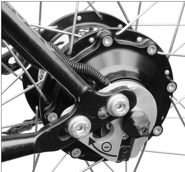
Rohloff SPEEDHUB 500/14 CC OEM montiert in Rahmen mit verschiebbaren Rohloff OEM Ausfallenden
