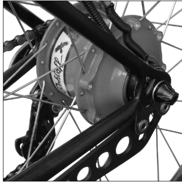
Rohloff SPEEDHUB 500/14 CC montiert mit langer Drehmomentstütze
