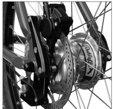
Rohloff SPEEDHUB 500/14 CC DB OEM2 montiert mit Rohloff SPEEDBONE und IS 2000 Scheibenbremse
